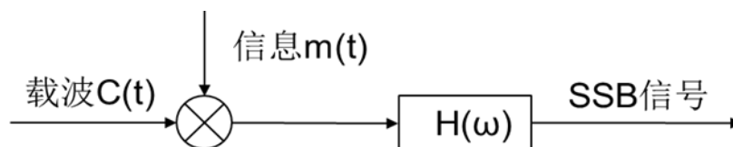
图 3.1 光滤波法原理图
