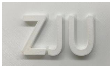
图 4.19 带有“ZJU”字母的 3D 打印树脂板
